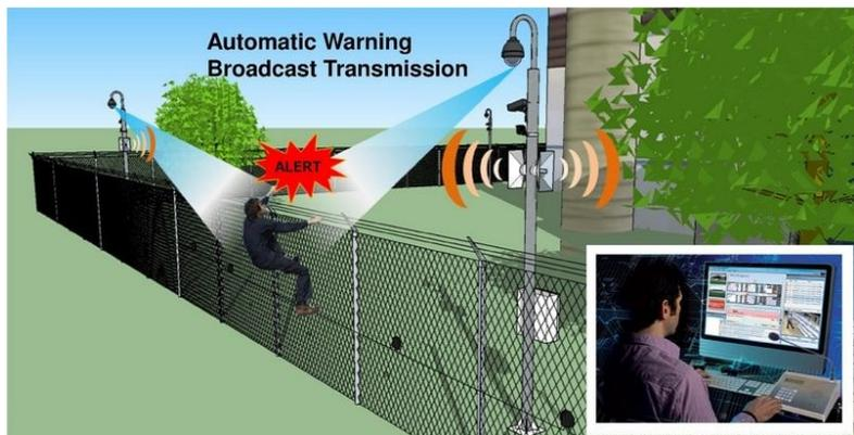
La EON SYSTEM aveva già previsto di installare lungo la recinzione del sito un sistema di allarme perimetrale suddiviso in zone, ciascuna videosorvegliate da telecamere in IP le cui immagini, visualizzate presso la control room, potessero consentire di monitorare la zona allarmata.
